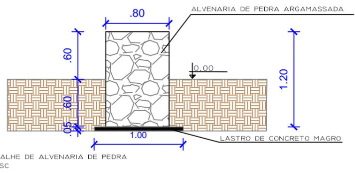
DETALHE DE ALVENARIA DE PEDRA S/ESC
